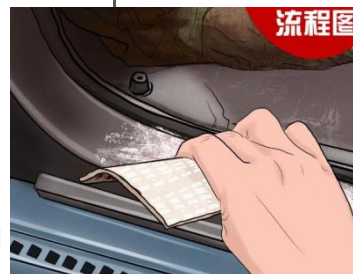
Шлифовка шпатлевки P120-P220
