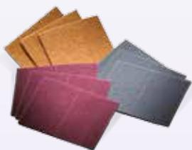
Большинство продуктов BearTex выполнено из нетканого нейлона, пропитанного абразивом на связке из синтетических смол. При этом создается мягкий объемный материал, обладающий отличной гибкостью и долговечностью. Равномерное распределение абразива по такому полотну обеспечивает однородную чистовую обработку.
